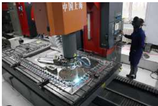
换热器板片激光焊接
